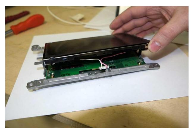
Аккуратно разделите дисплей на две части без демонтажа соединительного шлейфа.
