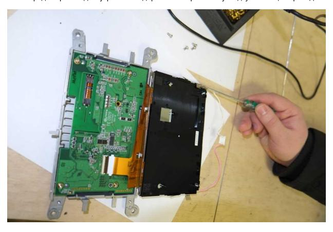
После укладки питающих проводом производим присоединение разъема питания и закрытие крышки дисплея.
