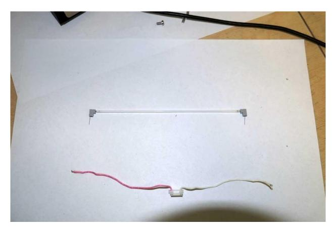
Готовим и производим замер новой проводки взамен неисправной П-образной CCFL лампы.
