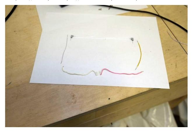
Производим пайку и усадку кембриков CCFL лампы.
