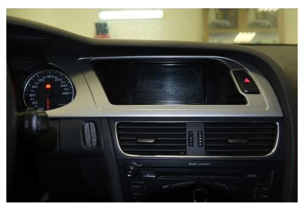
Демонтируем декоративную панель методом отжима с левой нижней стороны, так же для удобства рекомендуется отключить кнопку клемму аварийной остановки.
