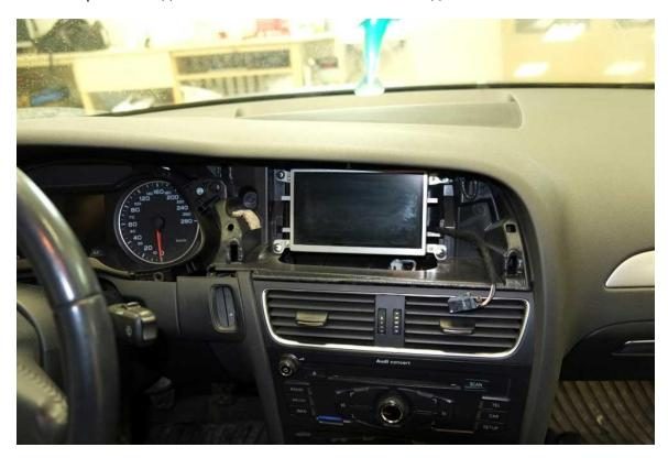
Отключите разъем соединения дисплея с модулей магнитолы и извлеките дисплей.
