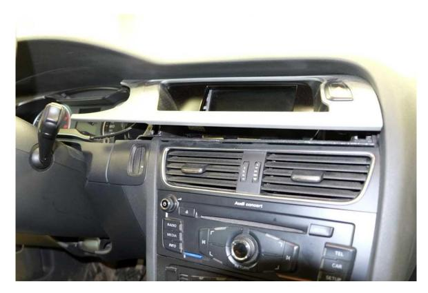
Выверните болты крепления дисплея ММІ и частично извлеките дисплей.
