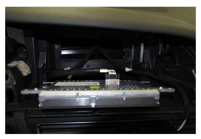
Расположите дисплей в удобном для разбора рабочем месте. Выверните болты крепления и отсоедините рамку дисплея (необходимо отжать два места крепления с одной стороны рамки).
