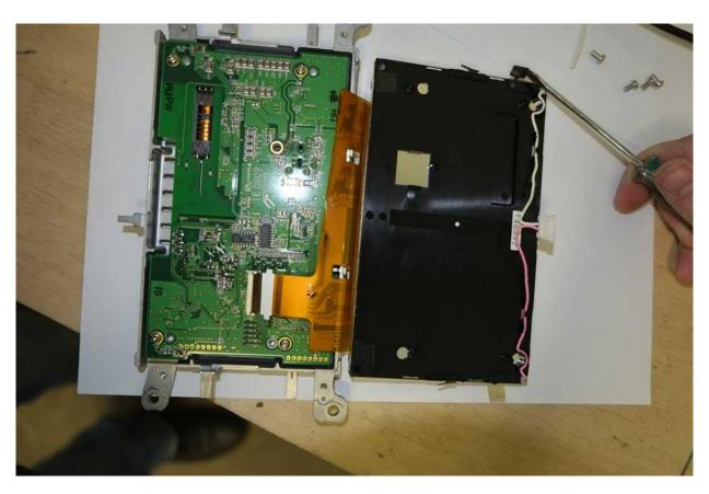
При извлечении сегмента дисплея с держателем CCFL лампы снизу остается стекло, на этом разбор корпуса закончен. Основная часть дисплея откладывается в сторону.
