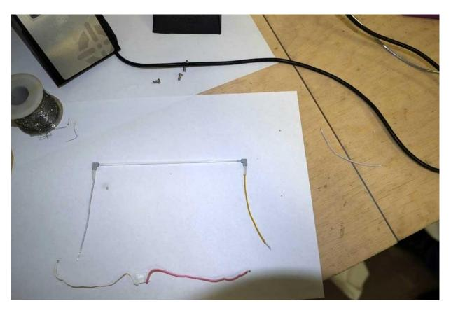
Производим пайку усадку кембриков для штатных проводов дисплея.
