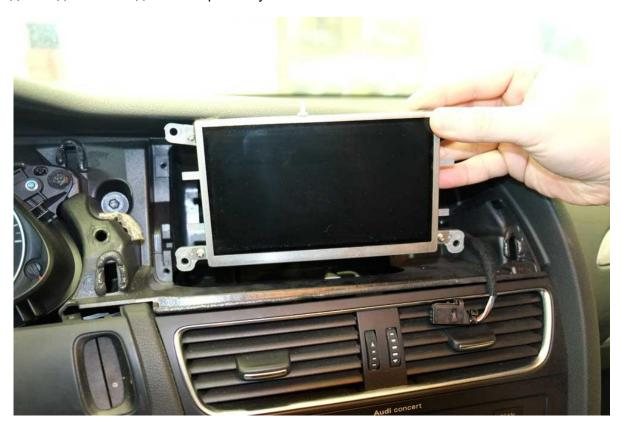
Проверяем равномерность подсветки и регулировку яркости дисплея со штатных кнопок.
