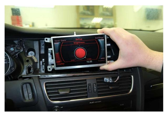
Производим крепление дисплея штатными болтами, момент затяжки болтов 2нм.
