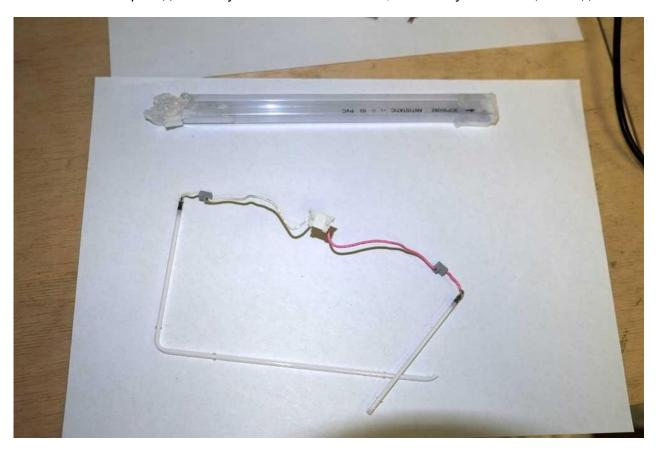
Берем новую CCFL лампу и используем на ней снятые уплотнители для исключения вибрации лампы в держателе и ее надежного крепления.
